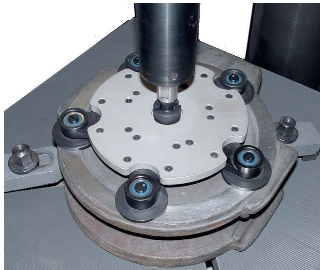
Schleifen eines Schieberkeils mit einer Planetenscheibe
